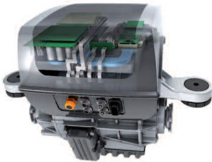
DrivePacEV80 – hoch integrierte und kompakte Antriebseinheit bestehend aus E-Motor, Getriebe und Leistungselektroniken (ausgezeichnet mit dem Innovationspreis Berlin Brandenburg 2011)
