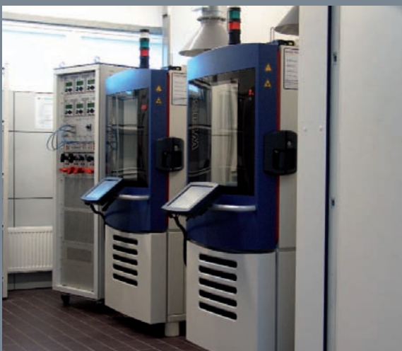
Zelltester bis 640 A und zwei Klimakammern
