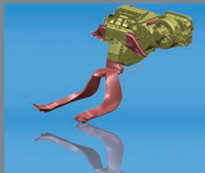
Phase 2: Konstruktion Klimagerät und der Luftverteilung
