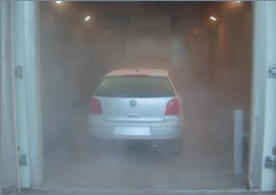
VW Polo bei einer Klimatemperlagerung bei +55 °C mit 95 % r.F.
