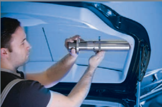
Kugelfallprüfung an der Fensterrahmenverkleidung
