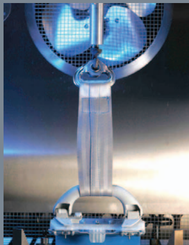
Belastungsversuch an einem Dachhaltegriff
