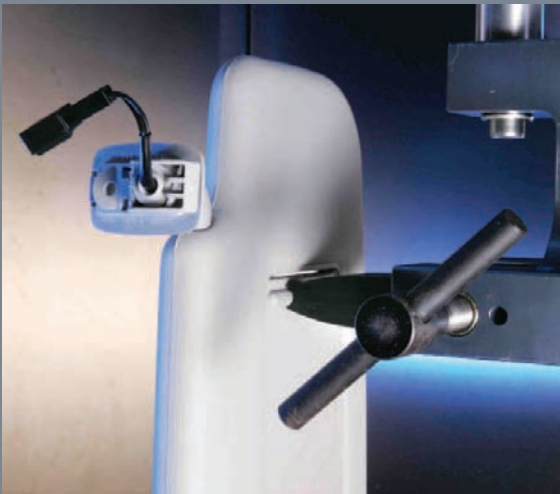
Dauerbetätigungsversuch Schieber Make-up-Spiegel
