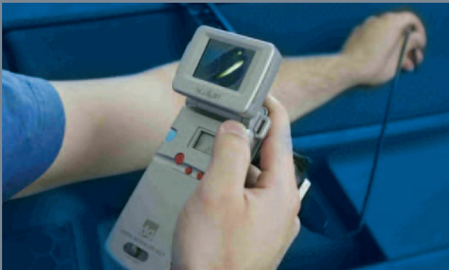
Endoskopische Untersuchungen mithilfe eines flexiblen Technoskops
