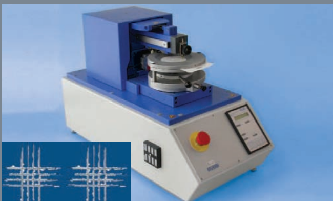
Gitterschnittprüfung (links: in Ordnung, rechts: nicht in Ordnung)
