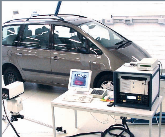
Messung der Oberflächenschnelle per Laservibrometer
