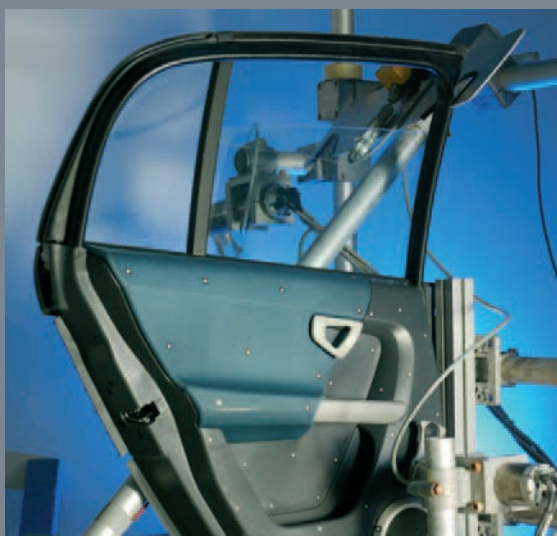
Die Fensterheber der smart forfour-Tür wurden in einem Prüfstand wie diesem einem Dauerlauftest unterzogen.
