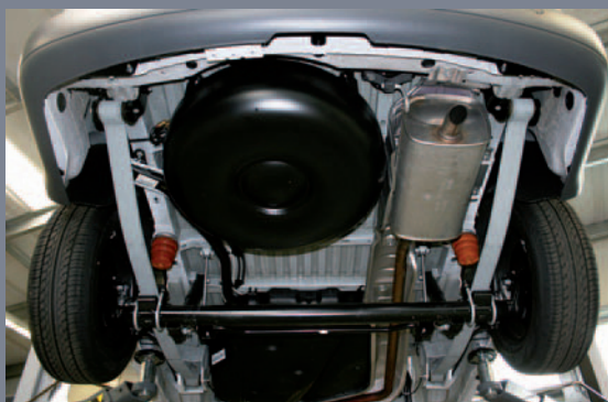
Anordnung Flüssiggastank im Unterflurbereich
