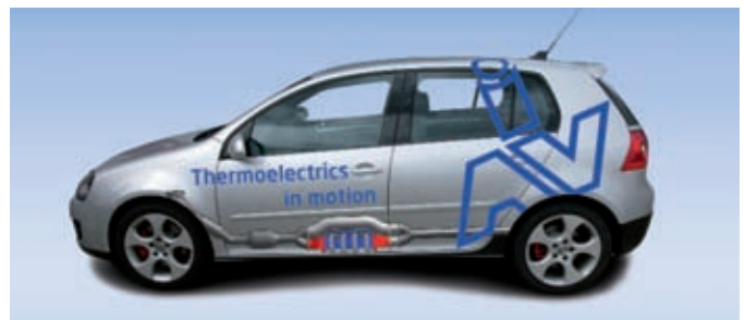
Das Experimentalfahrzeug der IAV für Tests von TEG-Systemen unter realen Bedingungen im Straßenverkehr
