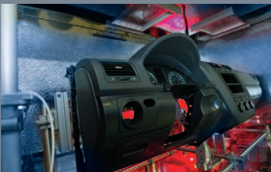
Voralterung und Klimawechseltest an einer Instrumententafel
