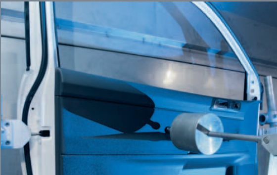
Kältelagerung und Armauflageprüfung an einer Türverkleidung
