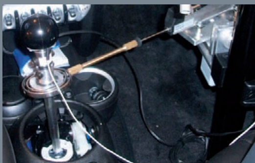
Messung von Schaltkraft/Schaltweg
