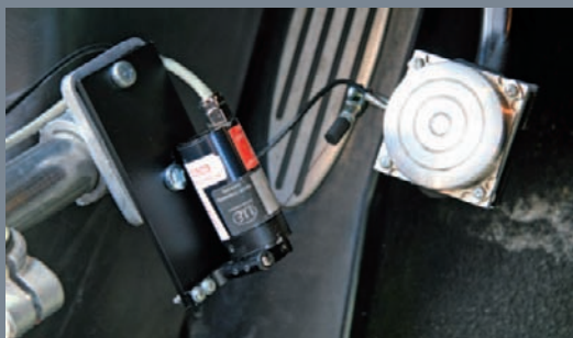
Messung von Kupplungspedalkraft und -weg
