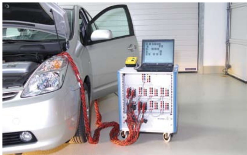
Bild 5: Messung von Ruhe- und Betriebsströmen an einem Fahrzeug
