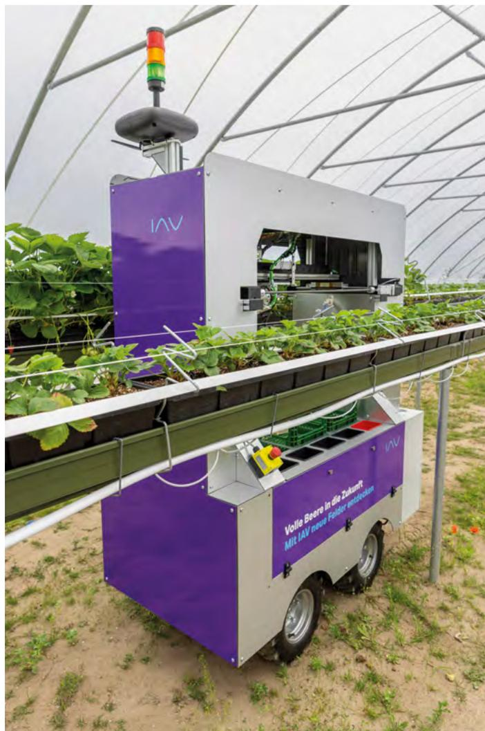
Ernteroboter in Aktion: Mit modernster Sensorik autonom unterwegs in Pflanzgängen. Der Greifarm lokalisiert die Erdbeeren, stuft sie nach Reifegrad ein und trennt die Früchte sorgsam ab.
