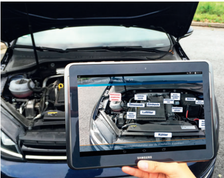
Lokalisation der Komponenten im Motorraum
